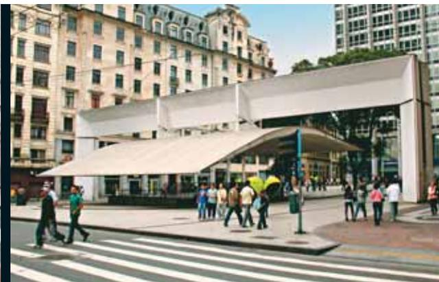
O pórtico em aço acolhe os passantes em sua sombra generosa e instiga os olhares. Tal cobertura foi pintada em branco e toda soldada, exceto a suspensão da casca, que precisou ser parafusada em quatro pontos na viga. Entre as chapas de aço superior e inferior, foram elaboradas nervuras internas para suportar as cargas dos ventos
